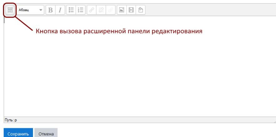
Это текстовое поле и панель редактирования текста. На рисунке отмечена кнопка, которая раскрывает панель редактирования в полный вид. Набор инструментов редактирования в целом совпадает с основными функциями большинства текстовых редакторов (большинство знакомы с Word) – размер шрифта, полужирный/обычный текст, вставка гиперссылки, вставка таблицы, списки, вставка изображения, цвет шрифта и т.д. Если у Вас есть опыт работы в Word, то и этот текстовый редактор больших сложностей не вызовет.
